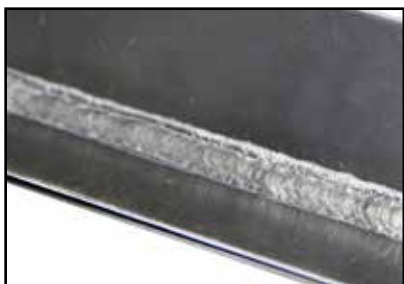
■ Alu Kehlnaht PB | 1,5 mm POWER.ARC
