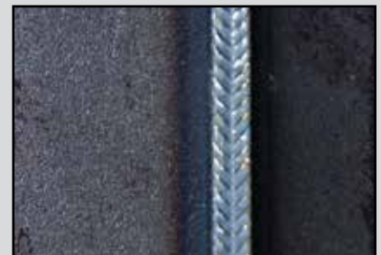
■ Stahl Kehlnaht PF | 5,0 mm POWER.PULS (als Doppelpuls)
