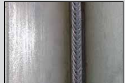
■ CrNi Kehlnaht PF | 5,0 mm POWER.PULS (als Doppelpuls)
