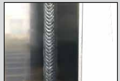
■ Alu Kehlnaht PF | 3,0 mm POWER.PULS (als Doppelpuls)
