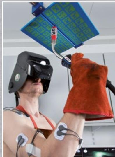
MB EVO PRO 36 in Schweißposition PE (Überkopfschweißen).
